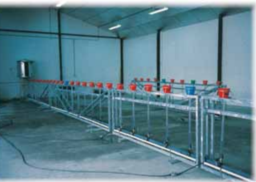
Instalación para la evaluación de emisores
