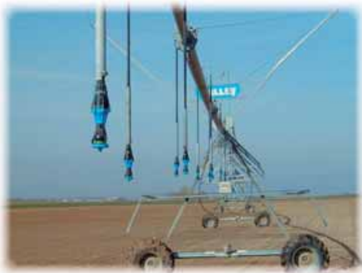
Toberas rotativas con montaje tipo Drops, evitan mojar la estructura
