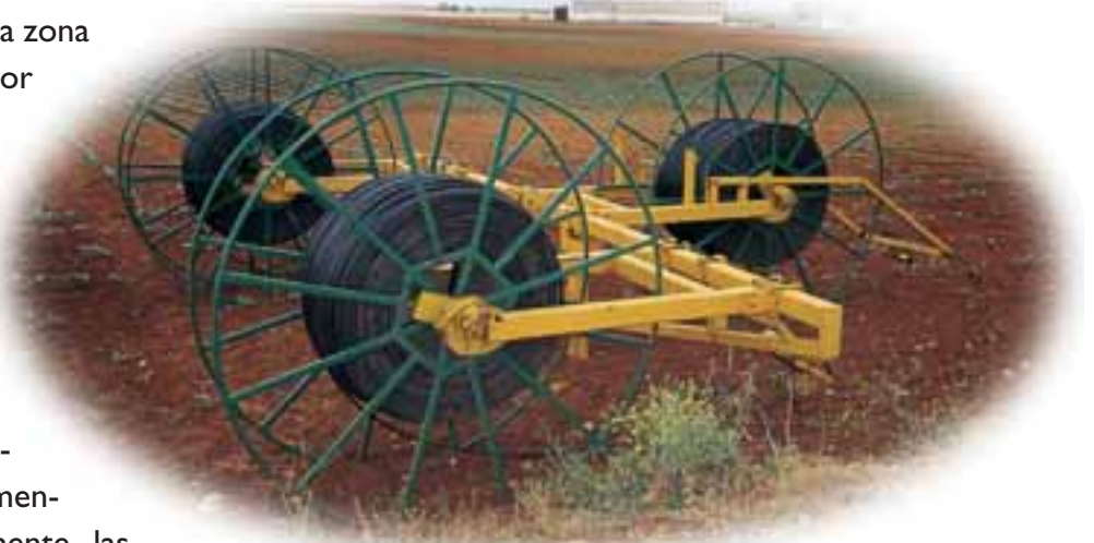
Sistema enrollador de tubería para riego por goteo
