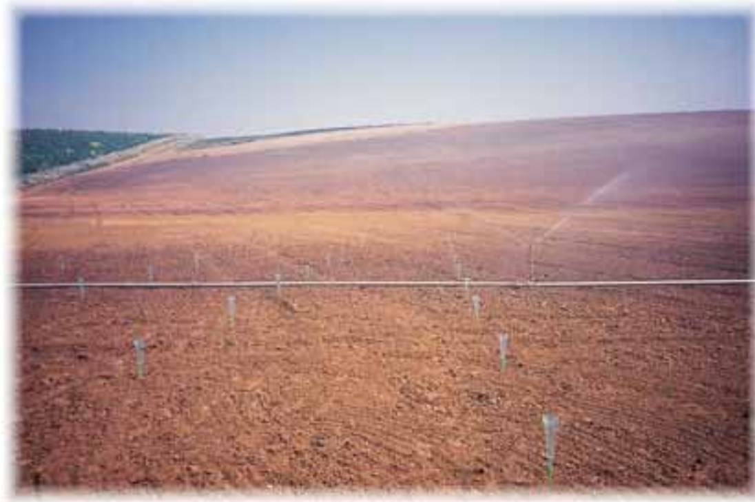
Evaluación de uniformidad en el campo mediante una red de pluviómetros
