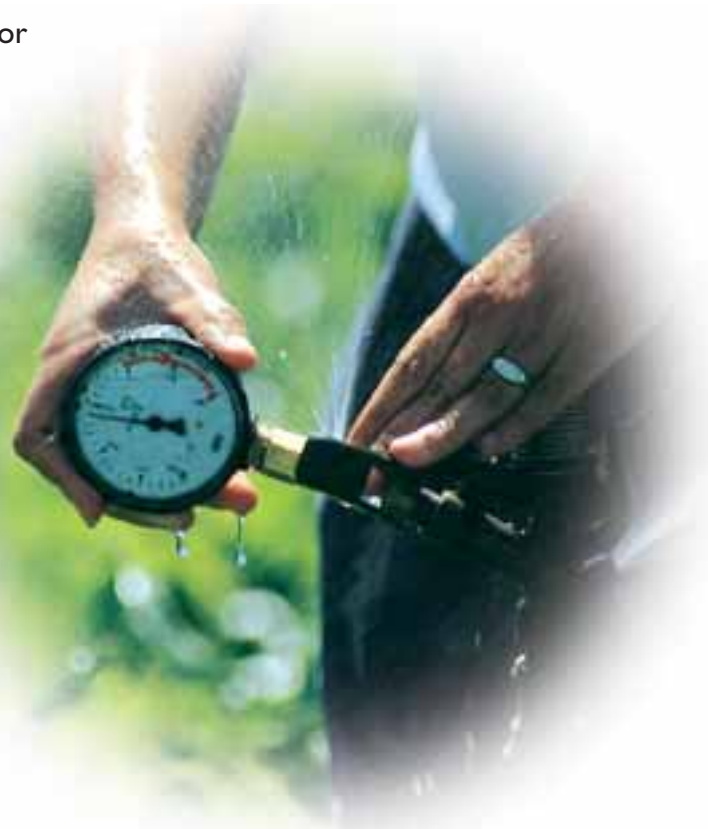
Medida de la presión de salida en boquilla
