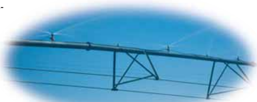
Pivote central: conducción portaemisores
