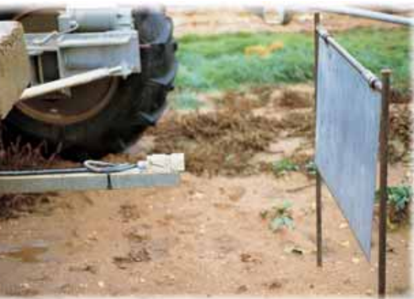
Detalle del sistema electromagnético para detección de final de trayecto en un pivote lateral multidireccional
