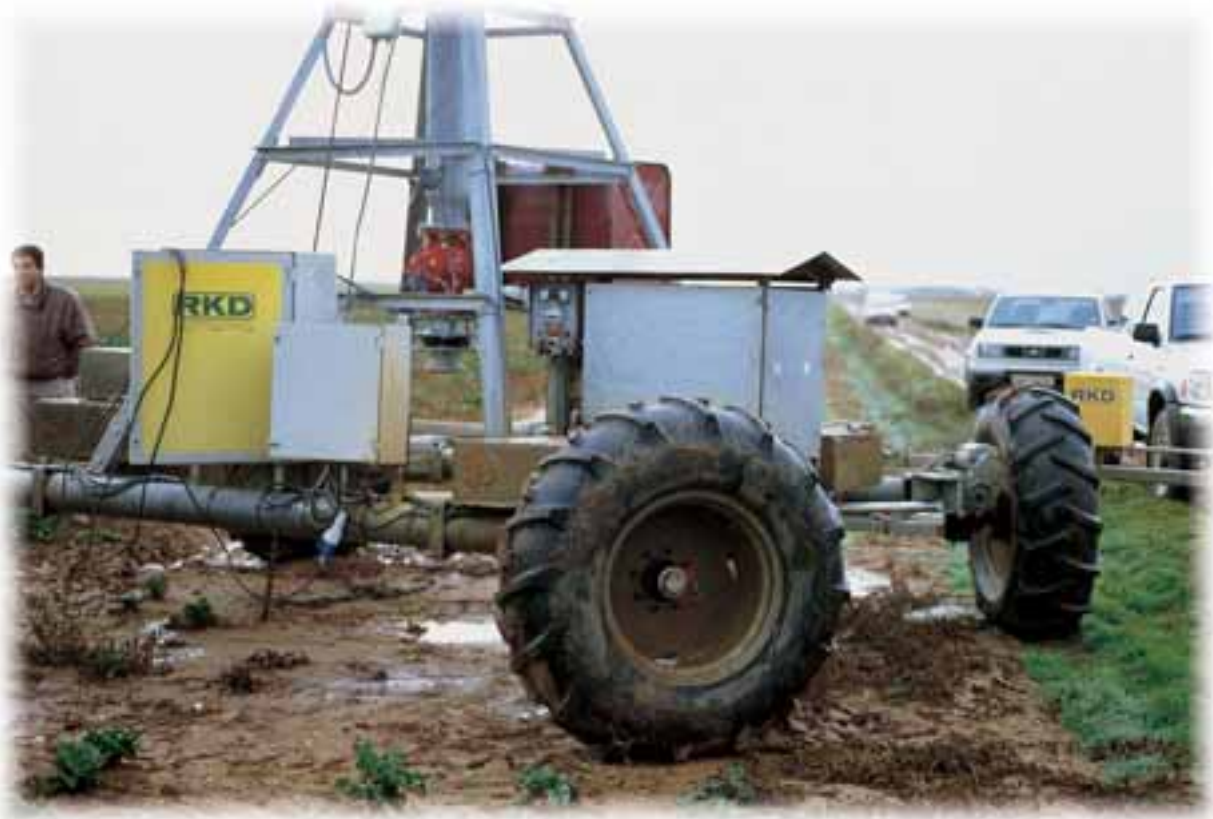
Giro de la torre para cambio de dirección en un pivote lateral multidireccional
