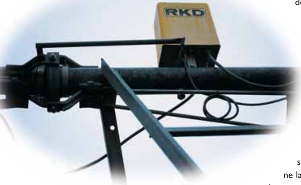
Pivote central: sistema de alineamiento por biela
